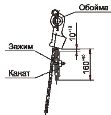
Крепление каната в клиновой обойме на оголовке стрелы
