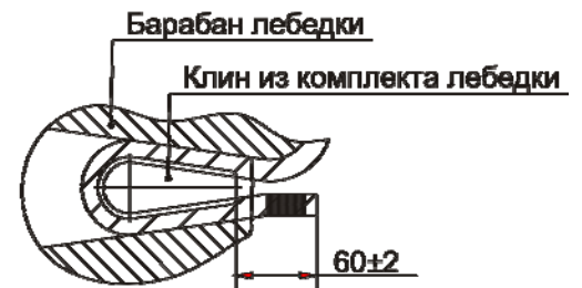
Крепление каната на барабане лебедки
