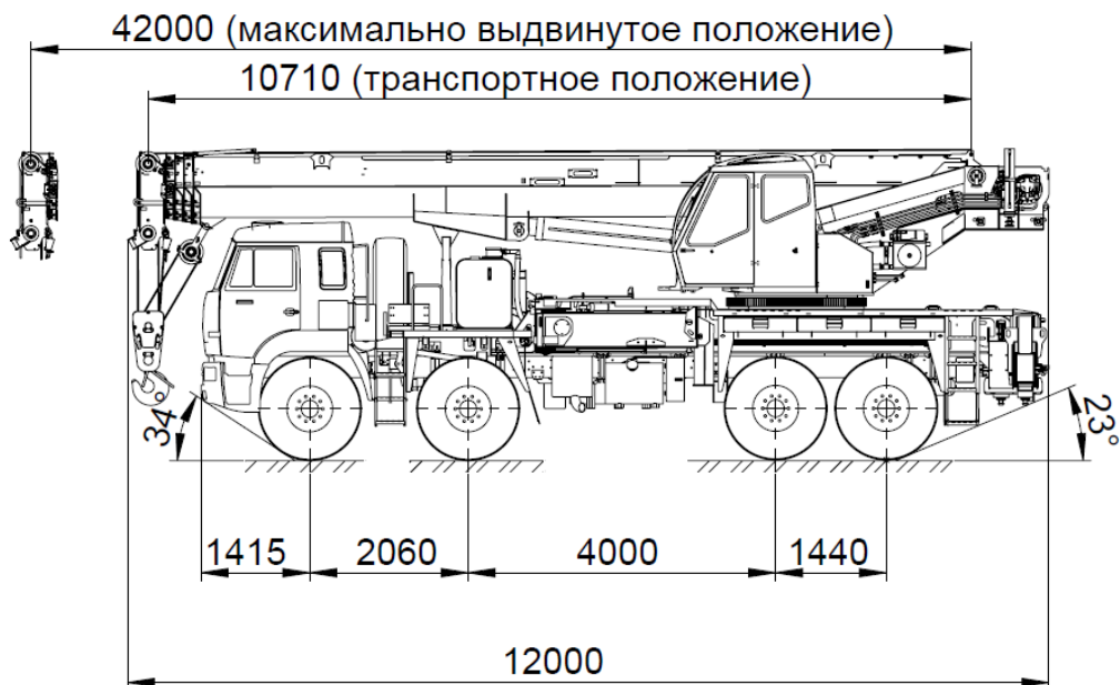
Рисунок 4 – Общий вид крана в транспортном положении (вид сбоку) без гуська
